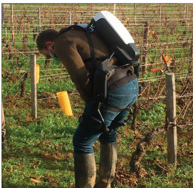
Le Vitilab expérimente un exosquelette pour que les tâches des viticulteurs soient facilitées.
