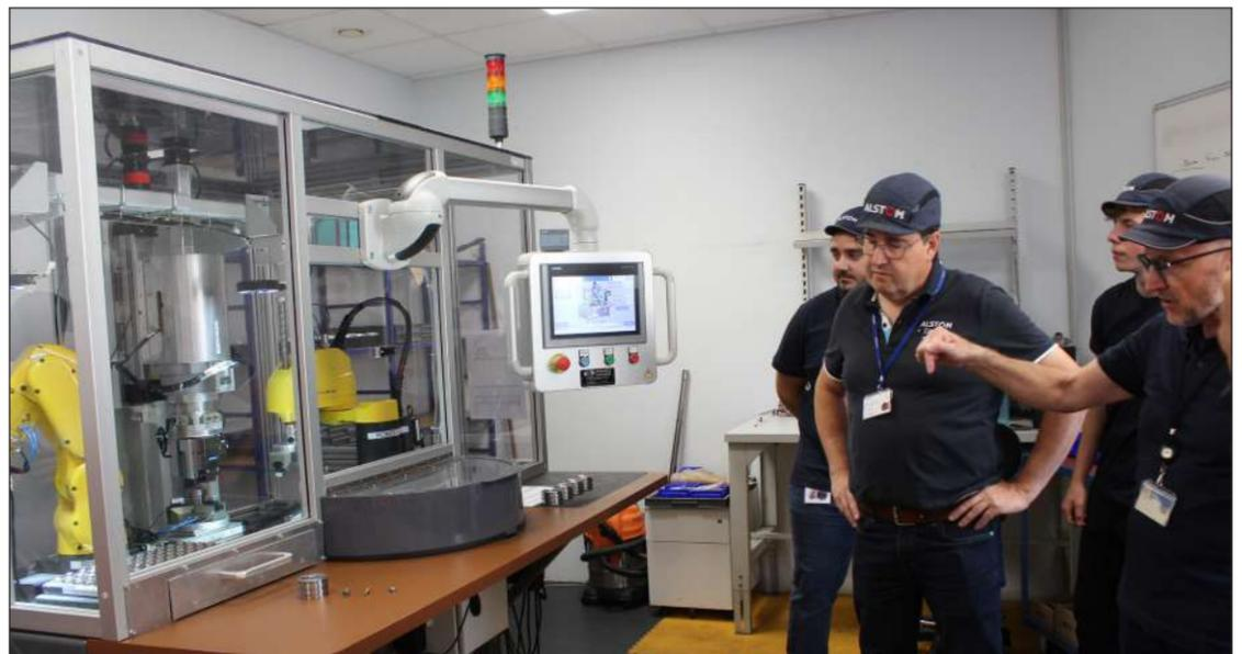
Automatisation, via deux robots Fanuc piloté par IA, pour un coût de 800.000 €, du réglage des pistons et embases des amortisseurs Dispens. Crédit : JDP.
