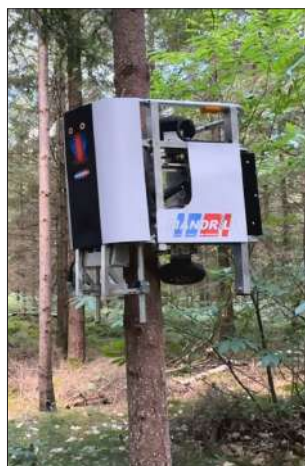
Derisys conçoit une machine électrique pour l'élague des résineux et la présentera au salon ForestInnov en novembre prochain. Crédit : Derisys.
